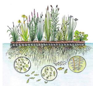
Reducir la presencia de nutrientes a través de las raíces de las plantas, mediante la instalación de islas flotantes y la revegetación de las orillas.
