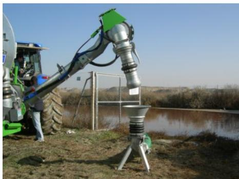
Recogida del purín en granja mediante embudo.
