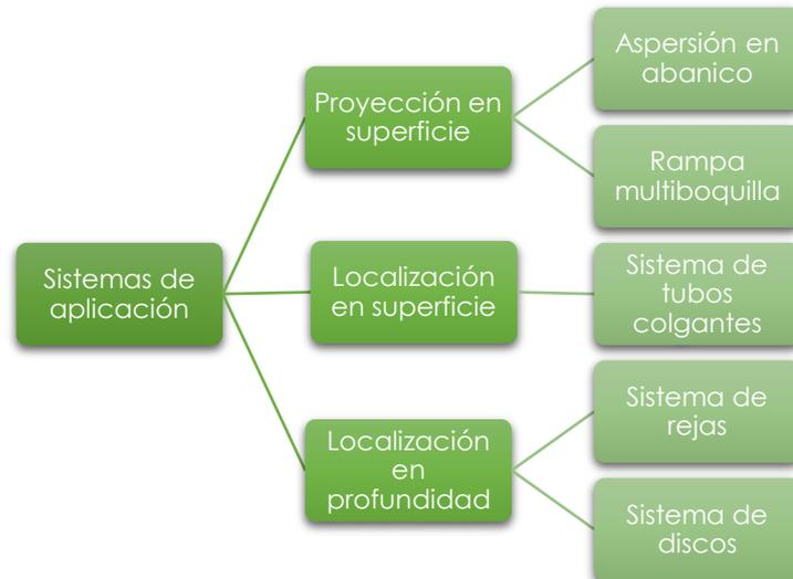
**Figura 2:** Sistemas de aplicación de purines en función de la distancia al suelo a la que realizan el aplicado
