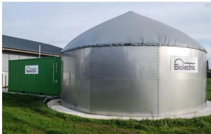
**Imagen 13:** Micro-digestor tipo Bioeléctrico. Granja lechera Dendauw en West-Flanders (Belgica).
