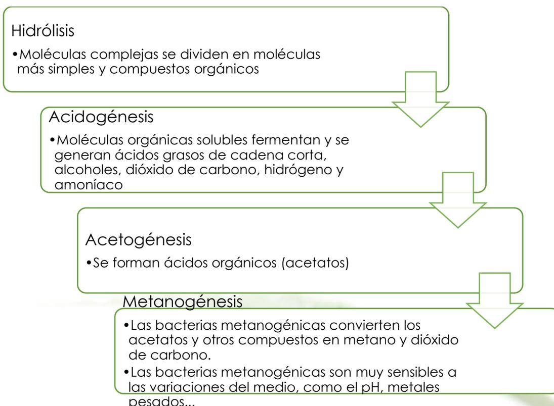
**Figura 6:** Fases de descomposición de la materia orgánica en los reactores
