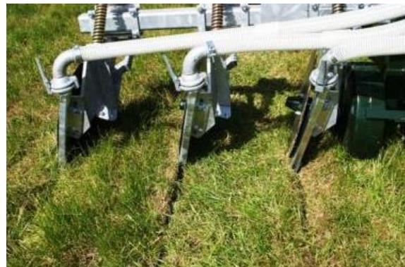
**Imágenes 10 y 11:** Sistema de enterrado de purines mediante discos y detalle de los surcos creados por este sistema
