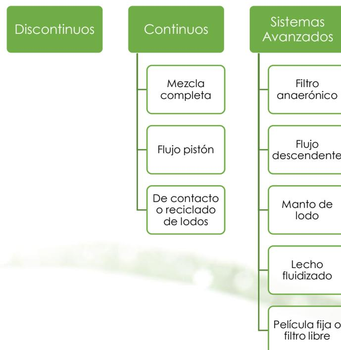
Figura 7: Principales tipos de reactores
