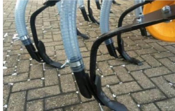
**Imágenes 8 y 9:** Sistema de rejas para la aplicación en profundidad del purín y sistema de rejas y detalle
