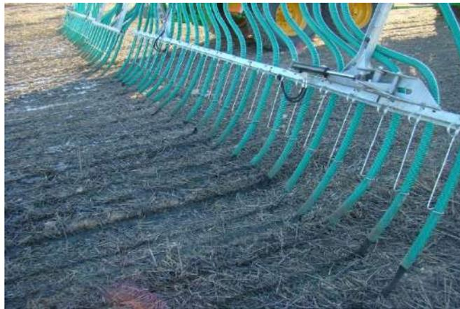
Imagen 7: Detalle de la aplicación mediante rampa con tubos colgantes
