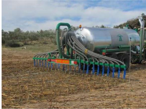
Imagen 6: Método de aplicación mediante rampa con tubos colgantes
