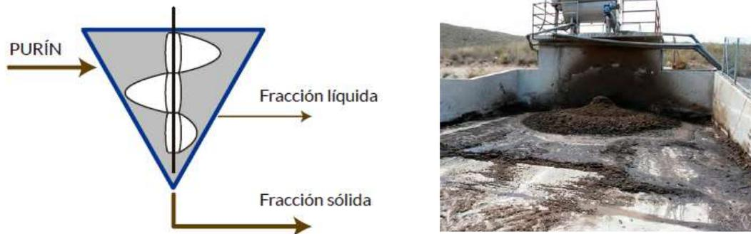
Figura 12 : Diagrama de sistema de separación por prensa de tornillo. En la imagen, fracción sólida obtenida tras aplicar este sistema.
